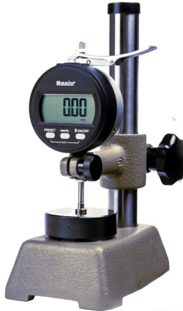
Medidor de espesores digital con resolución centesimal. Pantalla de grandes dígitos funciones de puesta a cero, conversión mm / pulgadas, entrada del valor de inicio, cambio del sentido de medida, y salida de datos USB.
