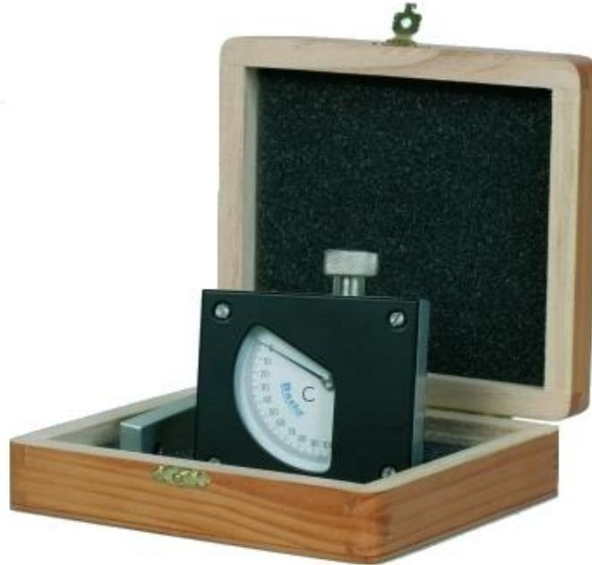
Para determinar la dureza Shore, escala C de probetas y artículos de goma de dureza media, según la norma ASTM D 2240. Se usa en los siguientes tipos de materiales: Gomas y plásticos de dureza media. Yesos y escayolas. Otros.
