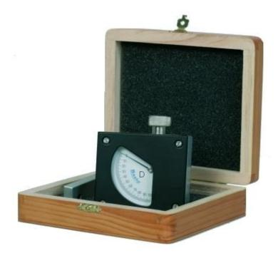
Para determinar la dureza Shore, escala D de probetas y artículos de goma de dureza media, según las normas UNE EN ISO 868, ISO 7619, DIN 53505 Y ASTM D 2240-15. Se usa en los siguientes tipos de materiales: Gomas y plásticos de dureza media. Yesos y escayolas. Otros.
