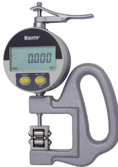
Medidor de espesores digital con resolución milesimal provisto de rodillos para la medición en continuo. Pantalla de grandes dígitos funciones de puesta a cero, conversión mm / pulgadas, entrada del valor de inicio, cambio del sentido de medida, y salida de datos USB.
