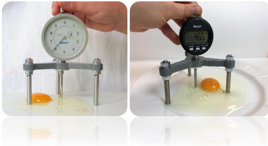
El micrómetro para la medición de la calidad del albumen del huevo le permitirá determinar con rapidez y precisión la calidad del recubrimiento de la albúmina del huevo. Este micrómetro le permite realizar la prueba de **Haugh**, que es el sistema más utilizado internacionalmente para la determinación de la frescura del huevo.
